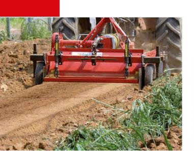
Costruita con una larghezza di lavoro da 125 a 210 cm, potenza richiesta da 40 a 90 HP e una profondità di lavoro da 15 a 25 cm. L'interratrice versione RSG con cofano baulatore è un'attrezzatura professionale che trova largo impiego nelle aziende orticole dove l'esigenza da parte dell'utilizzatore finale è quella di poter lavorare in
