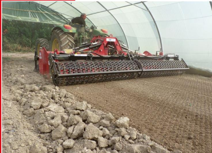
Construida con un ancho de trabajo desde 360 hasta 500 cm, potencia exigida desde 140 hasta 240 HP y profundidad de trabajo desde 15 hasta 30 cm.
