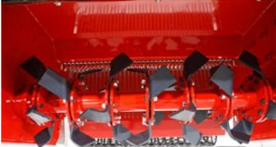
Die größere Distanz zwischen die zwei Antriebswelle bestimmt einen größeren Zwischenraum zwischen den Rotor und den Rahmen.
